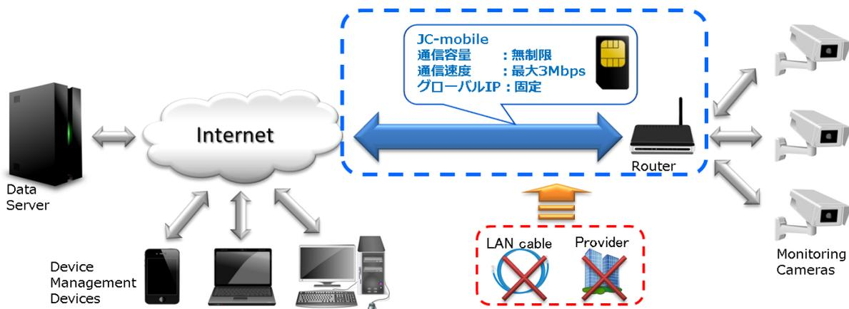
「JC-mobile」を活用することにより、通信線費用及びプロバイダー費用の大幅な削減、短期的・一時的な施工に対するリーズナブルな予算設定の実現、長期的な竣工におけるコストの定額化及び使用した機器を別の現場へリユースできるなどの効果が期待できます。
